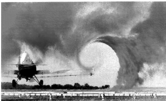
Abb. 8: Das Flugzeug fährt im Landeanflug über einen Behälter, aus dem Rauch entweicht. Das Bild zeigt, wie die Randwirbel den Rauch entgegen dem Uhrzeigersinn herumschleudern.
