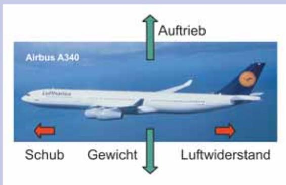
Bild 1: Gleichgewicht der Kräfte beim Flugzeug
