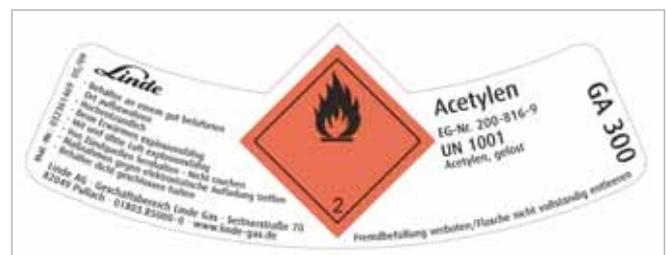
Abbildung 10: Etikett für eine Gasflasche nach Transportrecht und Stoffrichtlinie
